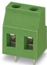
BJ pour C.I., Intensité nominale: 24 A, Tension nominale: 630 V, Pas: 7,62 mm, Nombre de pôles: 2, Mode de raccordement: Raccordement vissé, Montage: Soudage, Sens d'enfichage conducteur/circuit imprimé: 0 °, Coloris: vert, L'article est juxtaposable à différents nombres de pôles !
